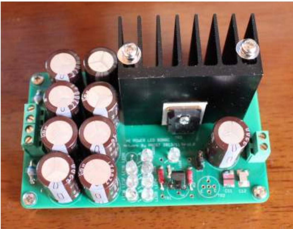
裏から見るとこんな感じ放熱用に開けた穴が 3.2mm だったので 4mm のネジを通すためドリルで穴径を拡張します、次回のロットは穴径を大きくして改善する予定
